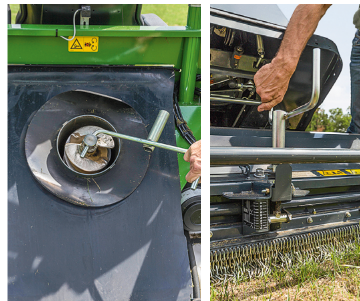
Die Aufsteckkurbel kann sowohl zum Einstellen der Schnitthöhe als auch zum Reversieren des Schneckensystems genutzt werden.
