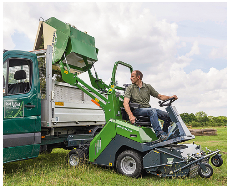
Hydraulisch auf 2,10 m angehoben wird der Bunkerinhalt bequem auf den Sprinter entladen. Fotos: Colsman
